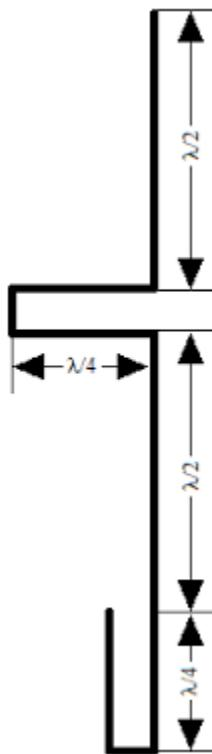
Dopo aver realizzato alcune J-pole standard, ho voluto "alzare il tiro" costruendo una Super J-Pole collineare. Si tratta di una variante che utilizza lo stesso principio costruttivo ma con elementi multipli in fase per aumentare il guadagno.
